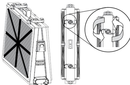
Setzen Sie die Filter gemäss das Diagramms wieder ein.
