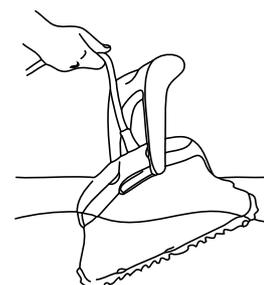
**Wichtig:** Ziehen Sie den Schwimmbad-Reinigungsroboter nicht mit Hilfe des Schwimmkabels aus dem Wasser.
